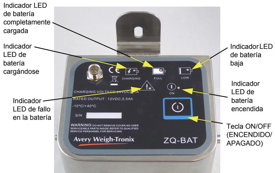
Figura 2.8 Parte superior del paquete de batería ZQ-BAT
